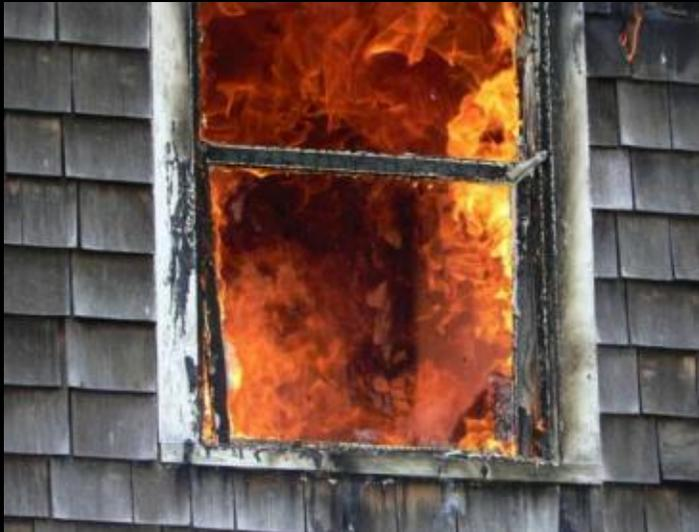
La temperatura dei gas di 300 °C è stata indicata come limite inferiore per raggiungere la rottura di un vetro (Riferimento Russo)
