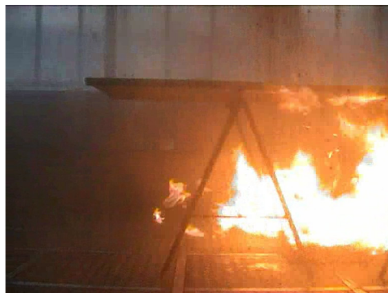
Figura 1 - Immagini corrispondenti ad un istante di poco successivo all'attivazione dell'erogazione water mist: A - sistema MAU; B - sistema DAU.
